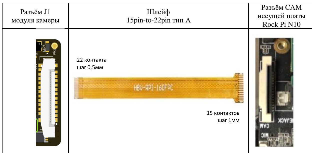
Рис.4 Физическое подключение камеры к модулю СКИФ.
