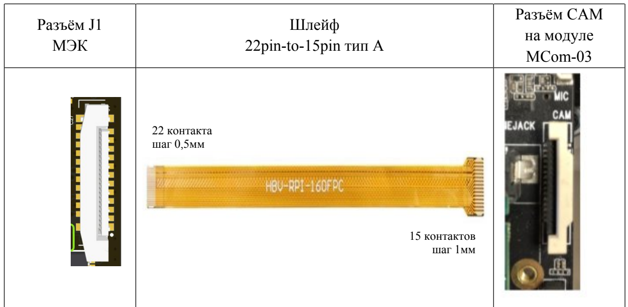
Рисунок 4 – Физическое подключение МЭК к модулю MCom-03
