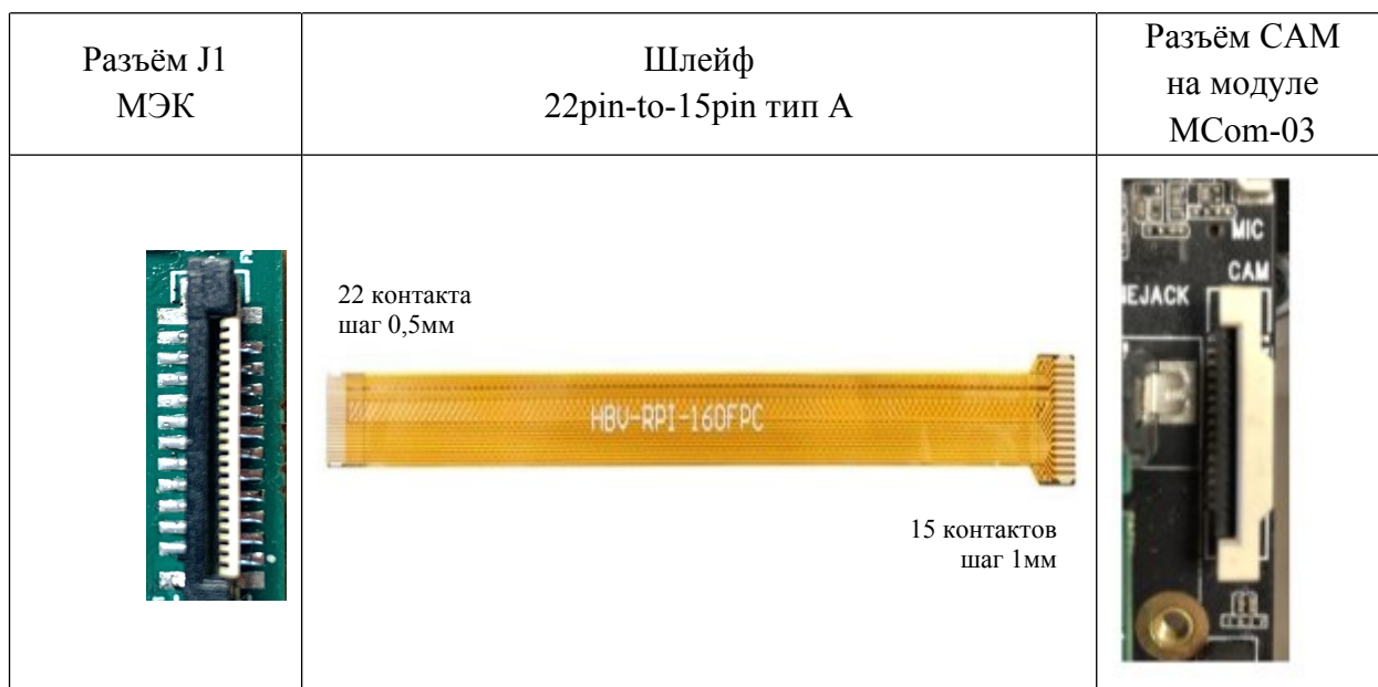
Рисунок 4 – Физическое подключение МЭК к модулю MCom-03
