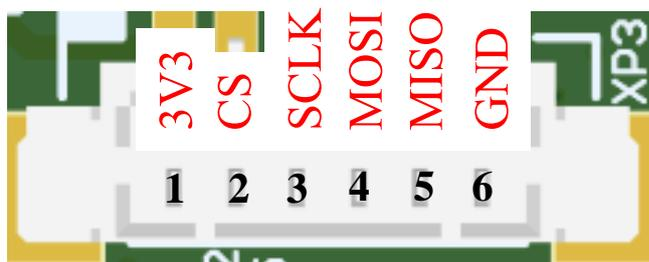
Рисунок 2.12.2 – Структурная схема интерфейса SPI
