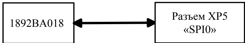
Рисунок 2.12.1 – Структурная схема интерфейса SPI
