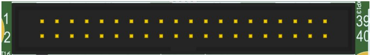
Рисунок 2.7.2 – Цоколевка разъема DIO
